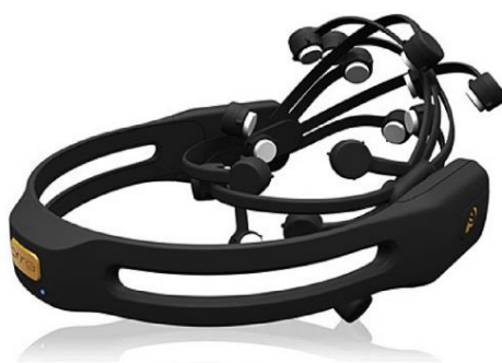
ภาพที่ 2-4 Emotiv EPOC Neuroheadset (Lacko, Vleugels, Fransen, Huysmans, De Bruyne, Van Hulle, & Verwulgen, 2017)
