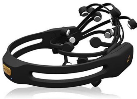
ภาพที่ 3-13 เครื่องตรวจคลื่นไฟฟ้าสมองรุ่น Emotiv EPOC Neuroheadset (Lacko, Vleugels, Fransen, Huysmans, De Bruyne, Van Hulle, & Verwulgen, 2017)
